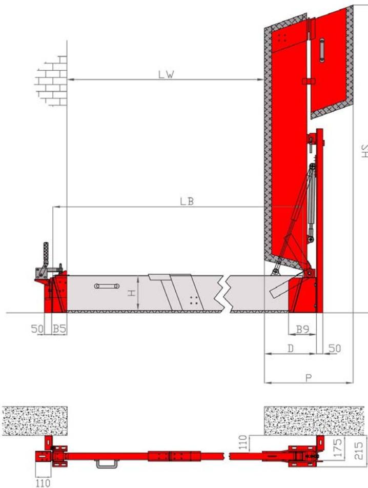
**BL/BED-KB (einfach drehbar, klappbar)**
